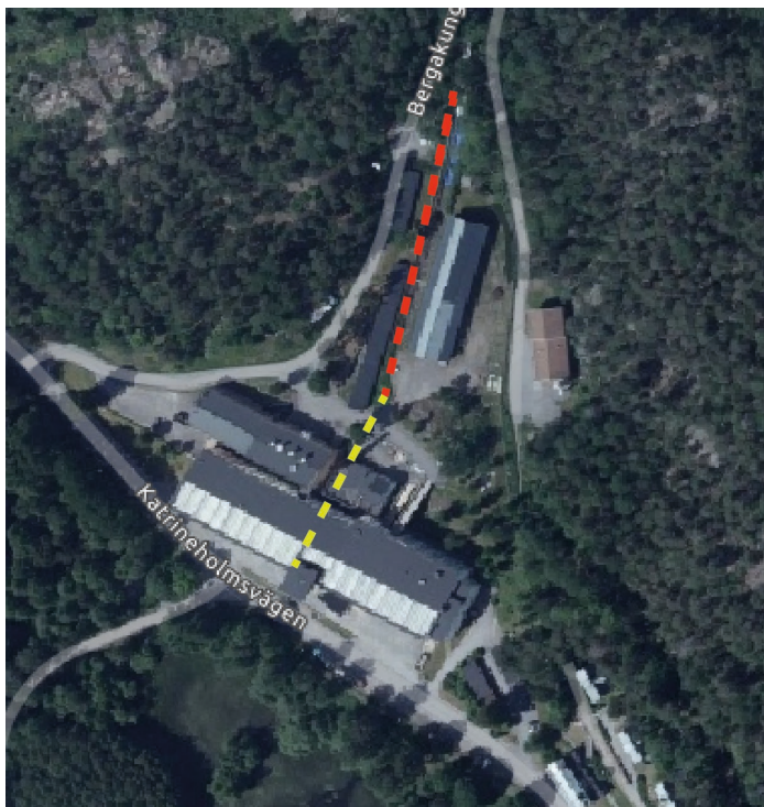
Figur 42. Kartan visar tubens sträckning genom planområdet. Röd streckad linje visar var tuben är ovan mark och gul streckad linje visar var tuben och kanalen kulverteras.
