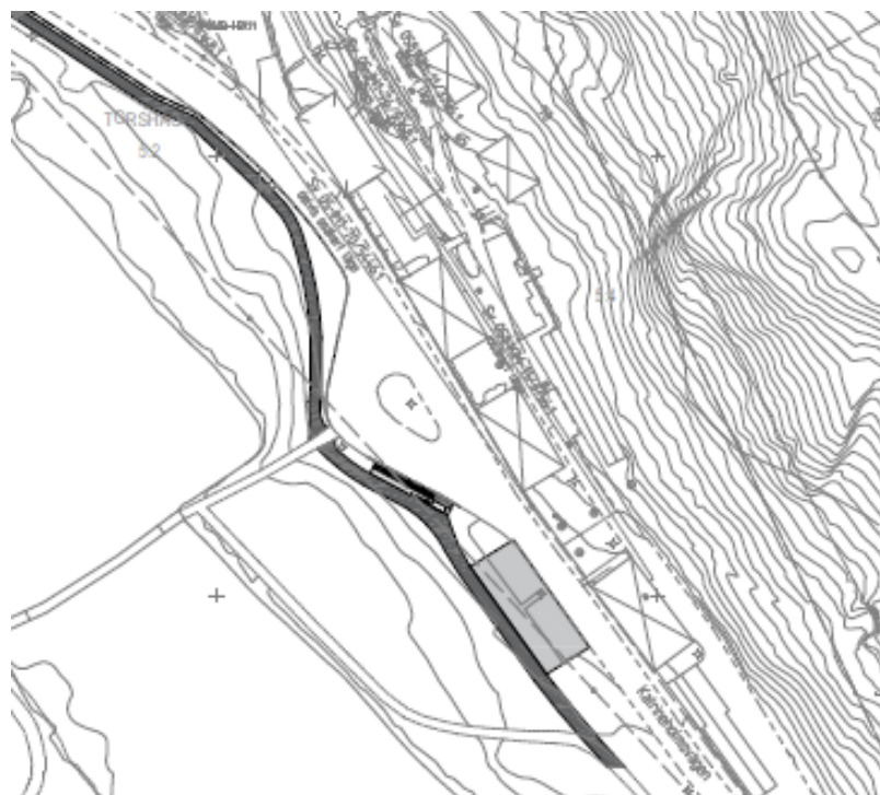
Figur 30. Bilden visar tidigt utkast på utformning av ny gång- och cykelväg i östra delen av planområdet där den kopplar på befintlig gång- och cykelväg. Källa: Norrköpings kommun.
