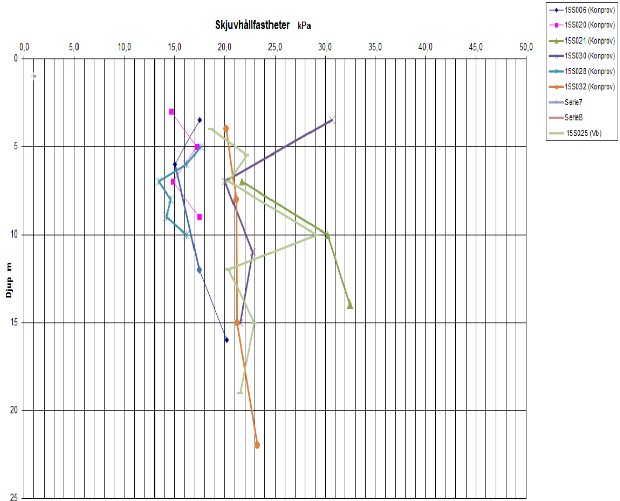
Figur 4.2.2: Sammanställning av lerans korrigerade skjuvhållfasthet i området från undersökningar år 2015
