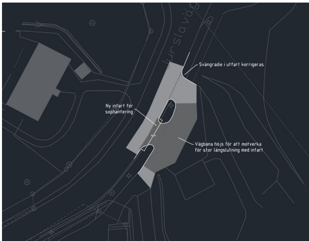
Figur 25. Förslagen angöring för sopbil efter utbyggnad av angränsande detaljplan, gällande förskolan Villan.
