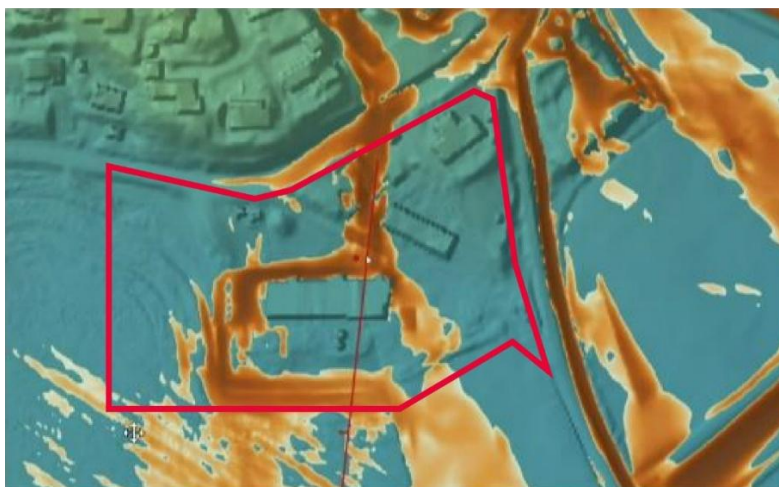
Figur 16. Modellering för extrema regn visar att en av rinnvägarna norr om planområdet leder betydande mängder dagvatten vid extrema regn genom området. Ungefärligt planområde är markerat i rött.
