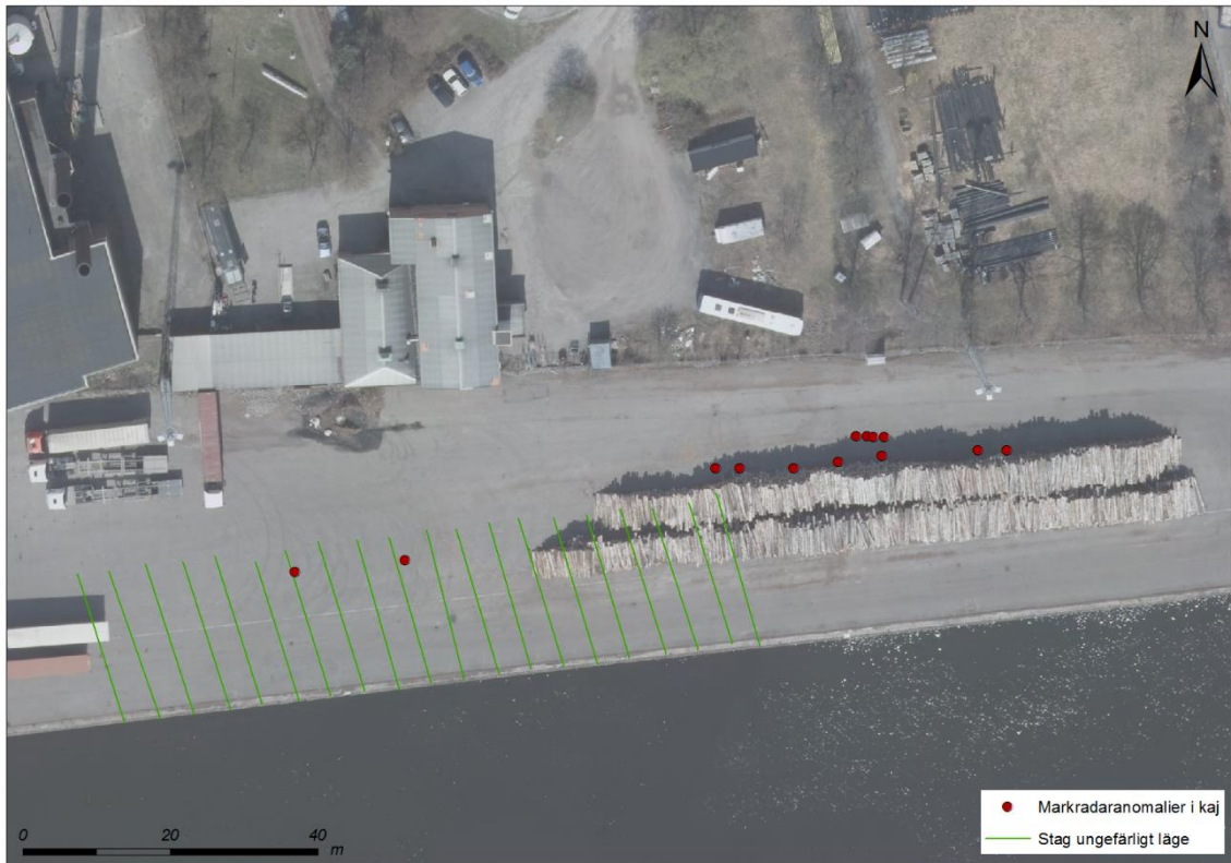
Figur 3: Markradaranomalier i kajen som inte har kunnat kopplas till befintligt ledningsnät samt ett mycket översiktligt läge på stagen enligt gamla kartor.
