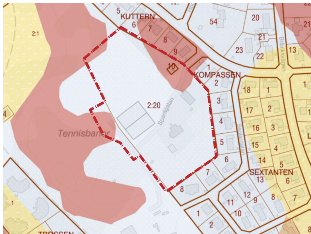
Figur18. Utdrag ur jordartskartan (2022-06-13). Rött: Berg i dagen, Blått: Morän. Gult: Glacial lera. Ljuskult: Postglacial lera. Planområdet är schematiskt inringat av en röd streckprickad linje. Källa: Norrköpings kommun.
