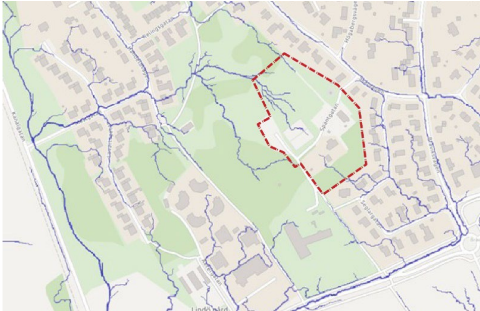
Figur 35. Rinnvägskartering - Scalgo. Planområdet är schematiskt inringat av en röd streckad linje. Rinnvägskarteringen visar i riktning vattnet rinner och hur flödesvägar ackumuleras. Rinnvägarna fortsätter tills de når havet. Källa: Norrköpings kommun.
