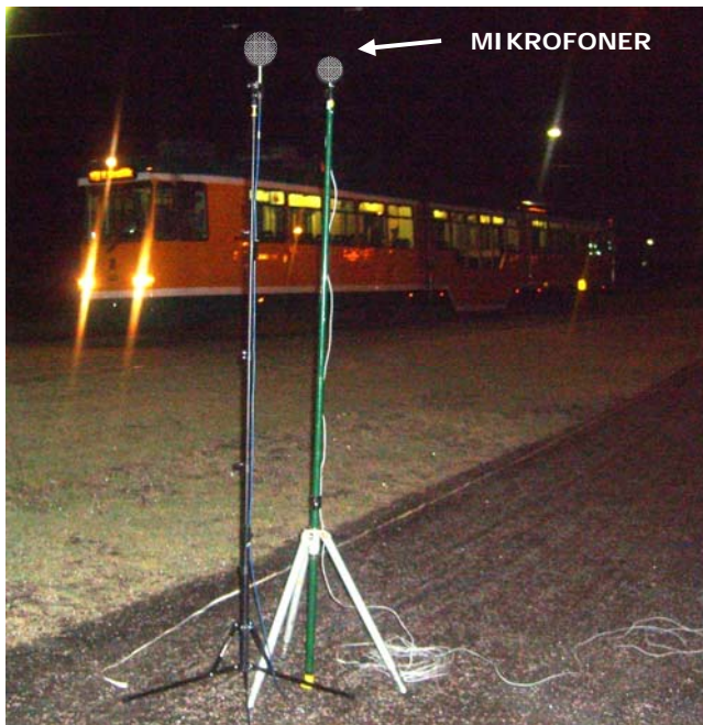
Foto 4. Mätmikrofoner vid mätpunkt 3
