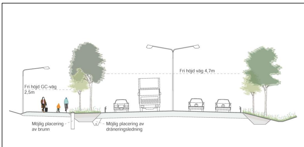
Figur 7. Den nya huvudgatan i sektion, på sträckan utmed Surgatan (se sektionmarkering i figur 5). Sektionen kan komma att påverkas av behovet för att ge plats för underjordisk infrastruktur. Källa: PM Gestaltning, Tyréns AB.
