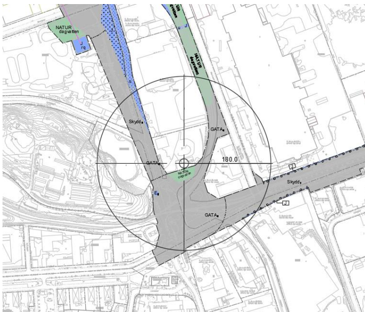
Figur 34. Inom 180 meter från gasolanläggningen på fastigheten Ångan 6 planläggs enbart för ändamål som inte är förknippat med stadigvarig vistelse, det vill säga GATA, NATUR i syfte att omhänderta dagvatten, teknisk anläggning för transformatorstation (E 1 ) och industrimark som inte får bebyggas.
