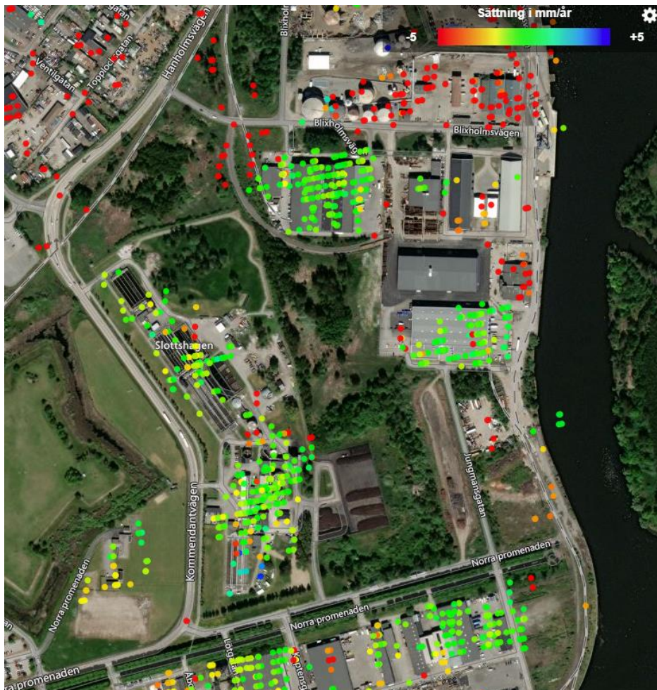
Figur 6.1. Pågående markrörelser enligt satellitdata. Bildkälla: www.sattningskartan.se . Datum: 2023-09-04.
